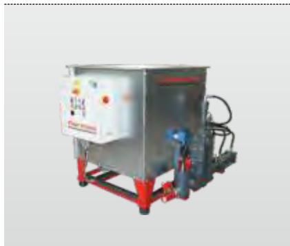
La série RB 20 – RB 80 SV : La presse à briquettes, petite mais puissante
